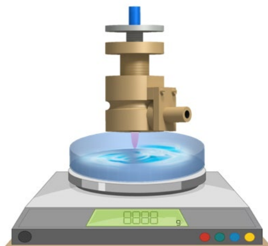
Figura 7: Análise da perda de massa com o passar do tempo de ativação do líquido pelo plasma.
