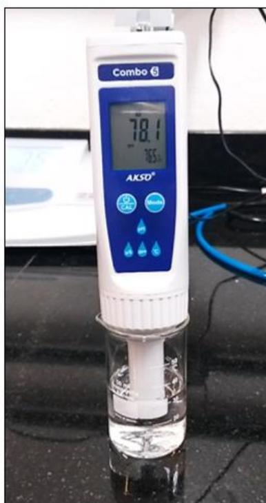
Figura 4.14 – Caracterização físico-química de uma amostra com medidor multiparamétrico de água.
