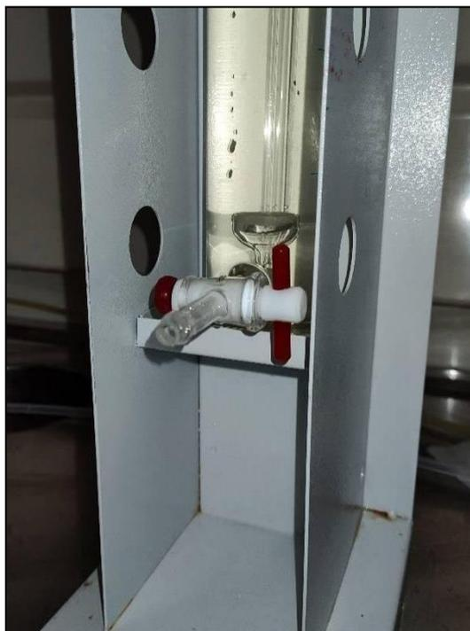
Figura 4.8 – Torneira localizada na parte inferior da torre ozonizadora, utilizada para coletar as alíquotas de água, durante a ozonização.
