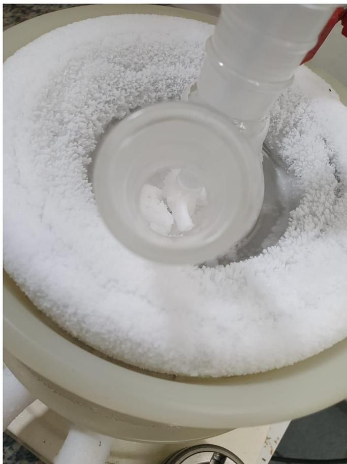
Figura 51 – Foto da mistura sulfonítrica congelada dentro do balão volumétrico.
