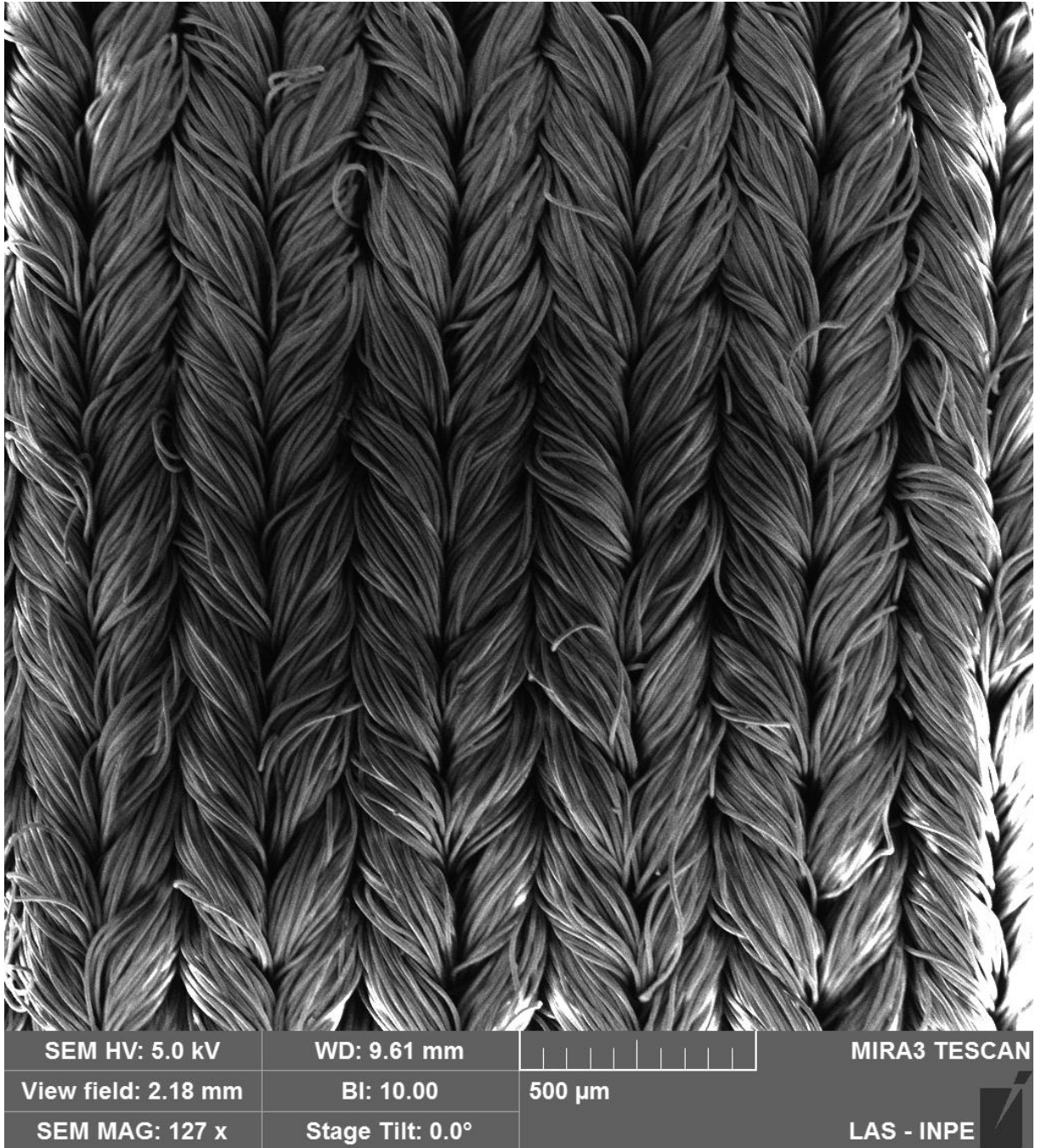
Figura 4.56 Amostra 3 PSA em argônio em 500 \mu\text{m} de amplificação.
