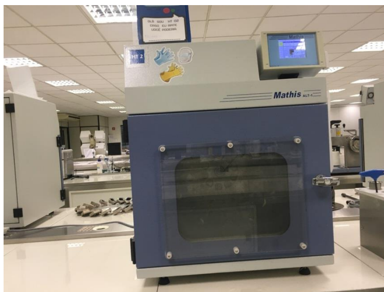
Figura 2.5 – Máquina de tingimento centrífuga para fixação do corante para o processo de tingimento por esgotamento da Golden technology. Fonte: (arquivo do autor).
