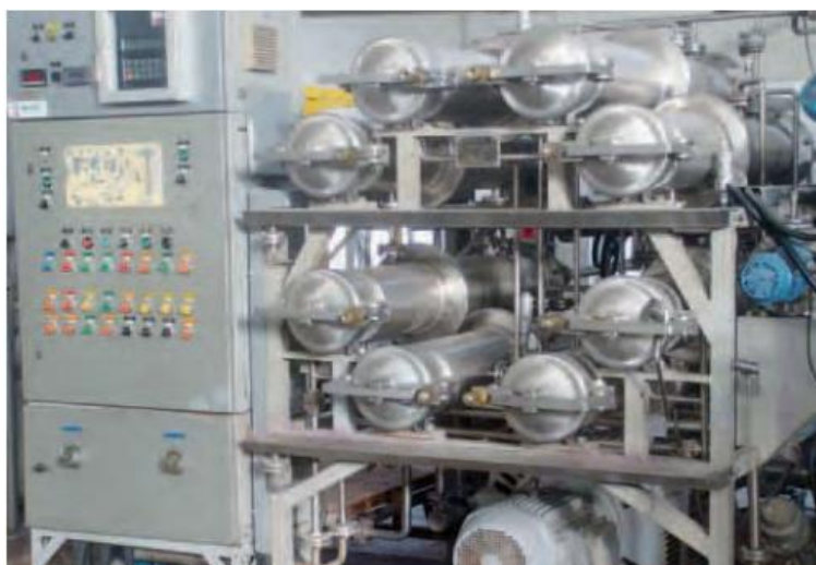
Figura 2.4 – Máquina para tingimento contínuo em bobinas. Fonte: (LTDA.; ARAGÃO, 2010).
