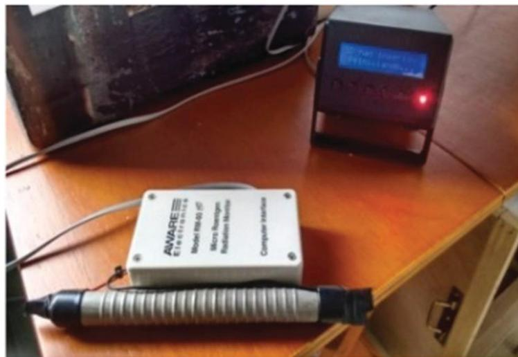
Figura 13 – Geiger com tubo Russo no datalogger instalado na torre do IAE – Fonte: O autor
