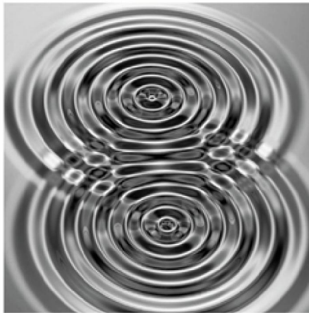
Figura 7 – Duas fontes vibrantes sobre a superfície da água produzem um padrão de interferência. O padrão observado é análogo ao que se observa no experimento de Young (YOUNG et al., 2009b).
