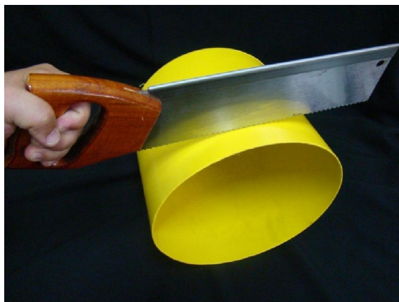
Figura 100a – Corte de um anel com largura de 2,8 cm a partir do cesto de plástico de 24,0 cm de diâmetro.
