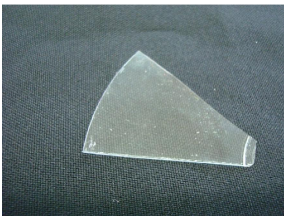
Figura 120 – Vista do CD sem a película metálica contendo a rede de difração.
