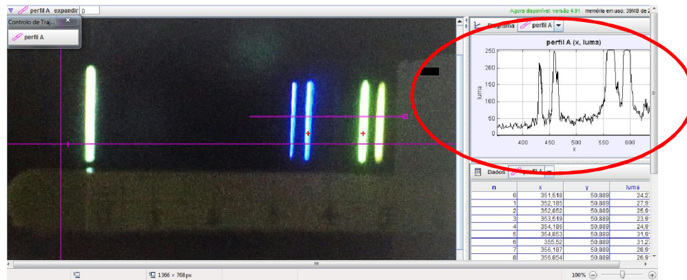
Figura 129 – tela do Tracker mostrando o gráfico da luminescência em função do comprimento de onda ( ).
