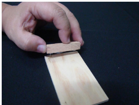
Figura 106b – Pedaços de madeira sendo colados na base de madeira.
