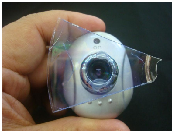
Figura 122b – Vista do CD colado na Webcam.
