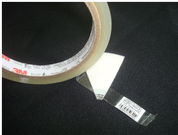
Figura 119a – Vista da fita adesiva colada sobre a película metálica refletora de alumínio do CD.
