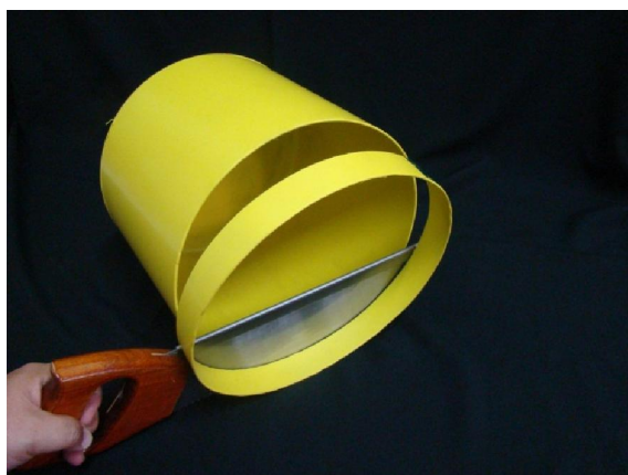
Figura 100b – Detalhe do anel com largura de 2,8 cm a partir do cesto de plástico de 24,0 cm de diâmetro.
