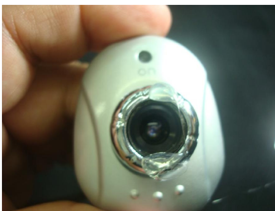
Figura 121b – Vista da cola quente na Webcam.
