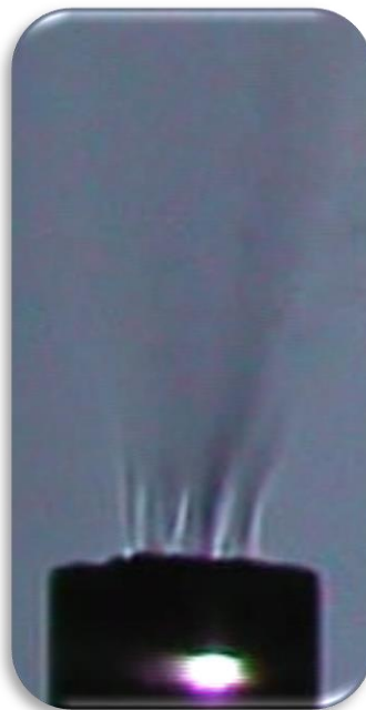
Figura 4.2 – Fotografia de Schlieren da saída do MP de Ar com potência de entrada de 8\text{W} e 8\text{ lmin}^{-1} para o fluxo de gás.
