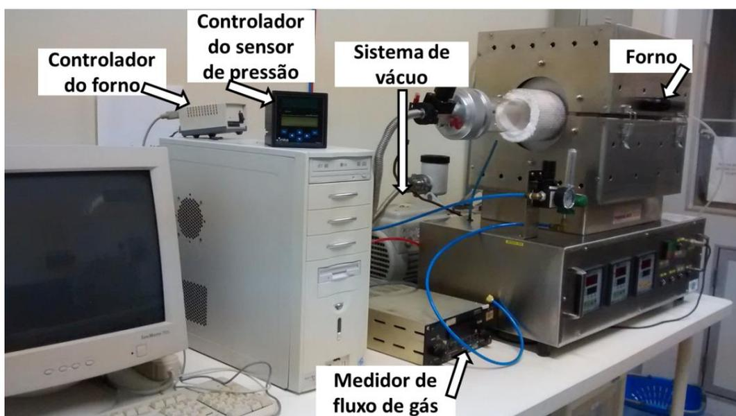
Figura 3.3. Aparato experimental utilizado tratamento de recozimento térmico de filmes e também sinterizações de materiais para montagem da DSSC.
