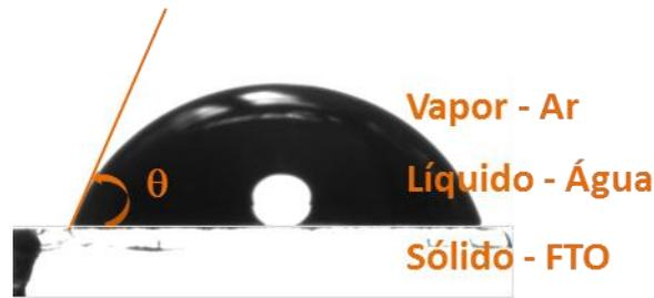
Figura 3.5. Imagem de ângulo de contato para uma amostra de N-TiO<sub>2</sub> depositada via DCMS.
