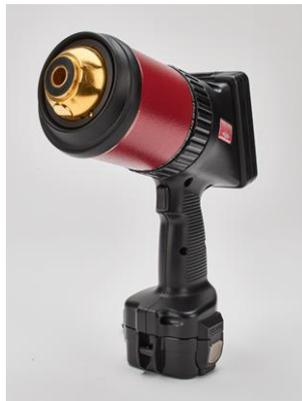
O ET-100 mede a refletância direcional em seis bandas na região espectral do infravermelho térmico, em dois ângulos de incidência: 20° e 60°. Baseado nesses valores a emissividade semiesférica total é calculada. O equipamento é calibrado com um cupom dourado especular medido com referência a um cupom medido pela NIST (*National Institute of Standards and Technology /EUA*)
