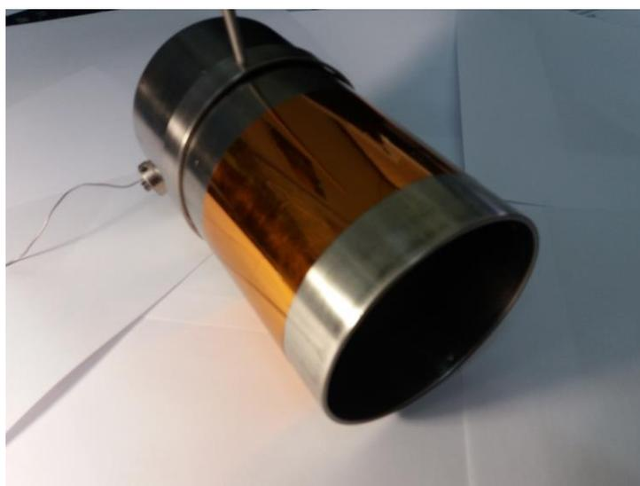
Figura 4.61 – Foto de filme de Kapton fixado por fora do suporte tubular conforme montagem da amostra utilizada no tratamento T33f.
