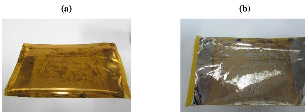
Figura 4.15 – Fotos do Kapton após o tratamento T1: (a) lado do polímero; (b) lado do alumínio. Esse tratamento, assim como o T0, foi feito sem o uso de tela metálica.
