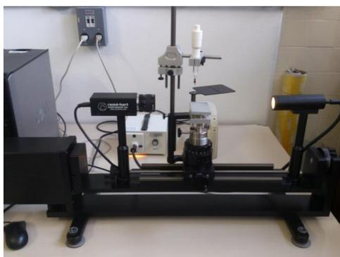
Figura 3.11 – Goniômetro *ramé-hart* modelo 500 do departamento de Física do ITA utilizado para medida de ângulo de contato de gota séssil.
