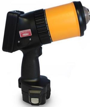
O Solar 410 é um refletômetro portátil utilizado para medida de refletância e absorção solar. Baseado numa esfera integradora, ele mede a refletância total em sete sub-bandas na região de 300 nm a 2500 nm do espectro. A refletância total, a difusa e a especular são fornecidas para os dados a 20° de ângulo de incidência. Vinte e uma medidas são produzidas durante cada aquisição simples. O sinal é normalizado por meio de um padrão interno do equipamento.
