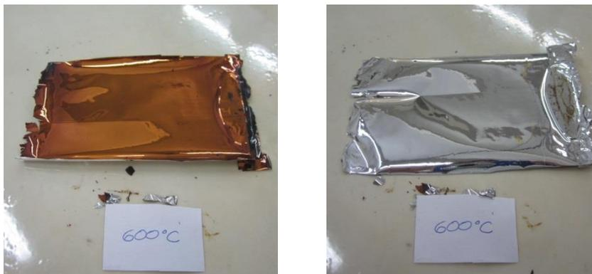
Figura 4.12 - Fotos das amostras de filme de Kapton aluminizado após aquecimento por 15 minutos em temperaturas de 300, 400, 500 e 600°C. As temperaturas estão indicadas nas figuras.
