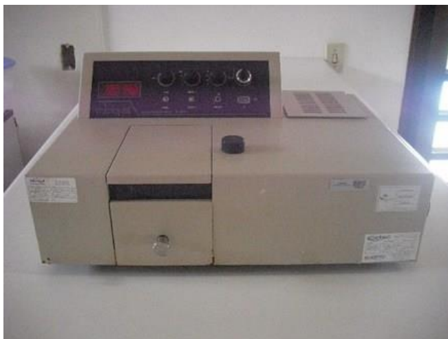
Figura 3.16 - Espectrofotômetro UV/visível da marca Micronal e modelo 380, localizado no laboratório químico de caracterização de metais – LQCM do Instituto de Estudos Avançados – IEAV em São José dos Campos – SP.
