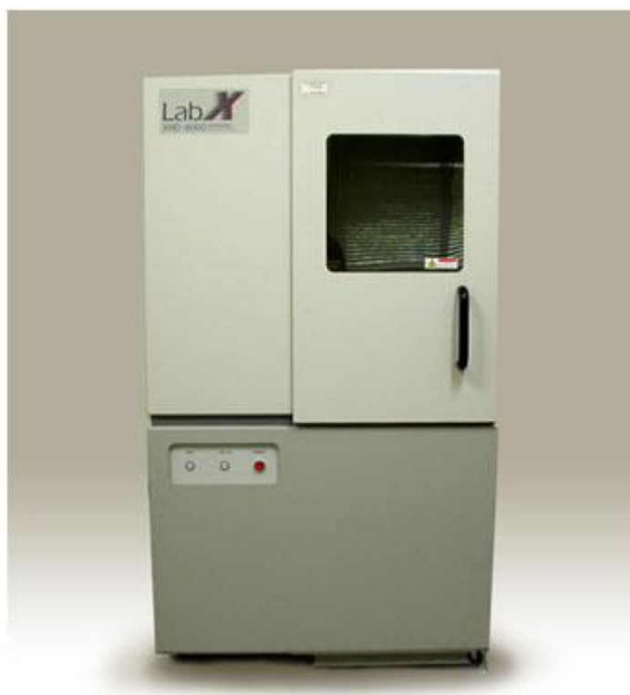
Figura 3.6 - GIXRD da marca Shimadzu (modelo XRD 6000) localizado no IP&D - Univap.
