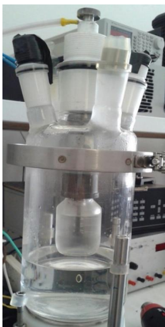
Figura 5.1 – Reator para descargas elétricas em líquidos.
