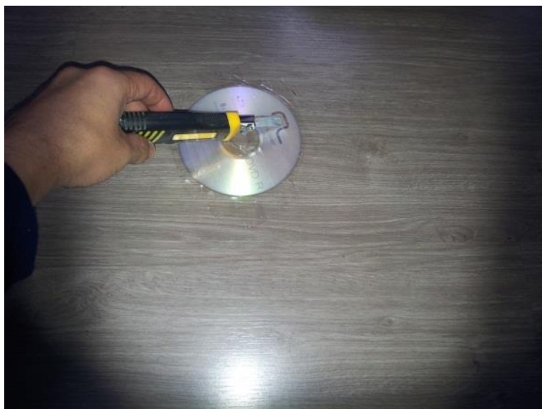
Figura B.13: retirada da rede de difração de um DVD.
