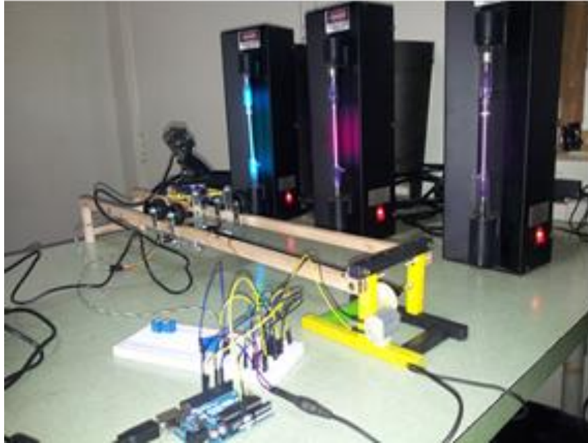
Figura 4.4: Estrutura física do experimento de espectrometria do WebLab-ITA
