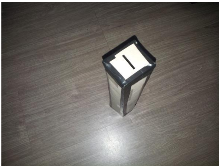
Figura B.12: montagem do corpo e fenda do espectrômetro caseiro.
