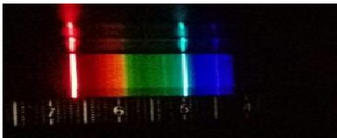
Figura 5.7: Imagem do espectro eletromagnético de neônio, obtido em laboratório presencial.
