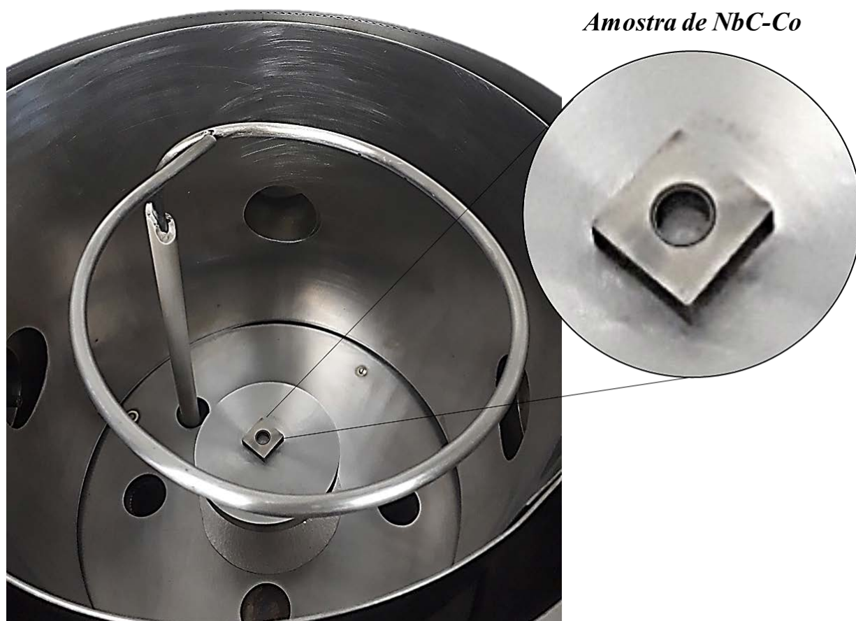
Figura 15 – Componentes de isolamento montados na câmara de tratamento com uma ferramenta de corte de NbC-Co.
