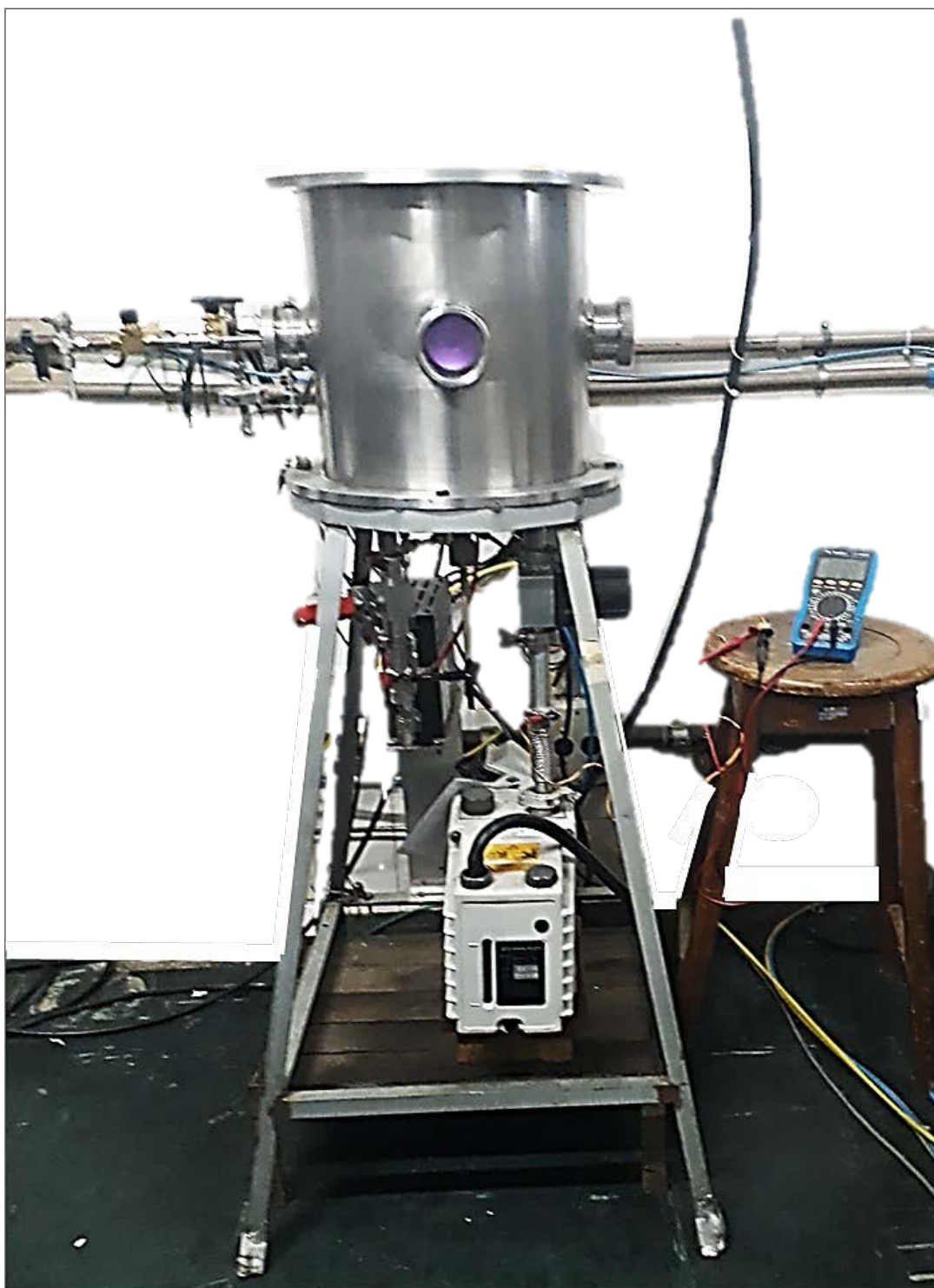
Figura 13 – Sistema de tratamento por plasmas de parede simples, com aquecimento direto por plasma. Pertencente ao Laboratório de Plasmas e Processos (LAB-PP), laboratório vinculado ao Instituto Tecnológico de Aeronáutica – ITA.
