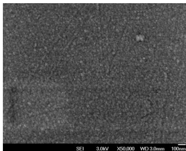
Figura 28. Micrografias por MEV-FEG de filmes da liga FeAlCr obtidos a uma distância de deposição do alvo de 125mm.
