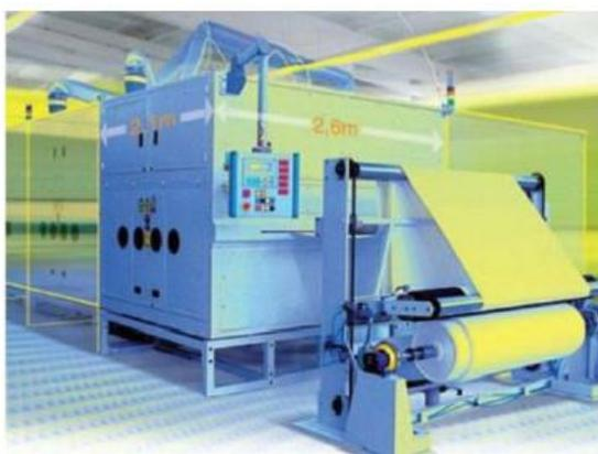
Figura 8: Equipamento para produção industrial de nanofibras [37].
