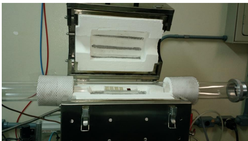
Figura 3.12: Fotografia do forno aberto mostrando o posicionamento das amostras no seu interior sobre um porta-amostra de quartzo.
