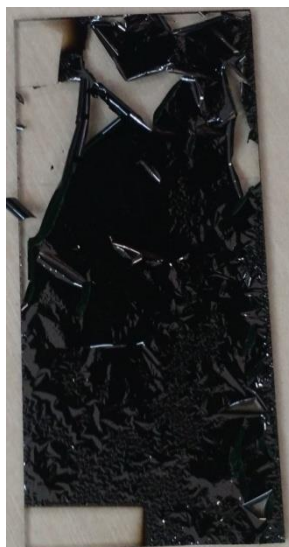
Figura 4.1: Fotografia do filme de carbono delaminando do substrato de vidro (56 mm x 26 mm).
