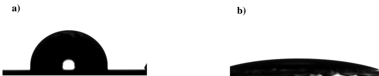
Figura 4.25: Fotografias da gota d'água sobre a superfície do filme de carbono apenas a) tratado termicamente (amostra CTT) e b) após submetido ao processo de texturização a plasma (amostra CTT-H2-45).
