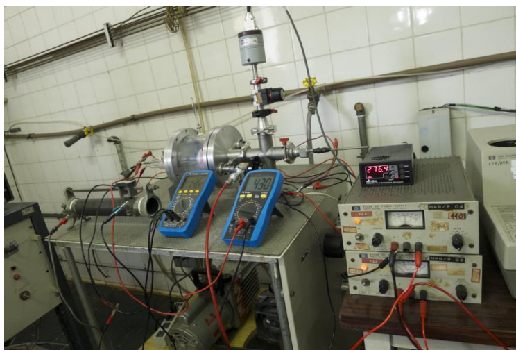
Figura 12 – Aparato experimental para estudos de uma descarga de eletrodos planos convencionais. Laboratório de Plasmas e Processos do ITA.
