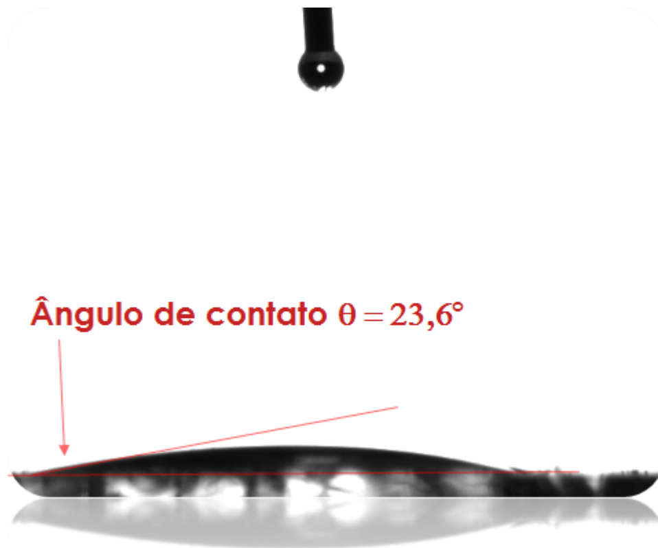
Figura 4.18: Teste da molhabilidade para vidro não tratado.
